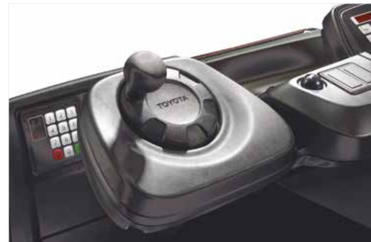
Modely BT Reflex N-série nabízejí 360° řízení pro intuitivní a citlivé ovládání.
