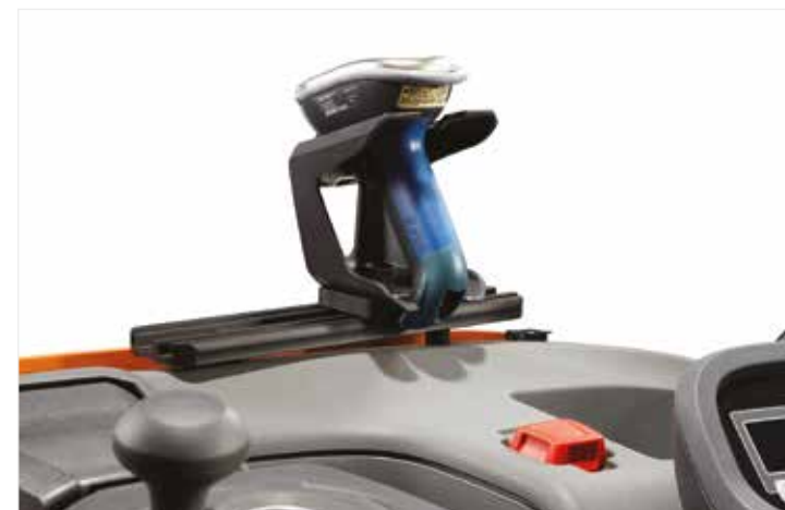
Volitelný úchyt E-bar pro připevnění pomocného vybavení.
