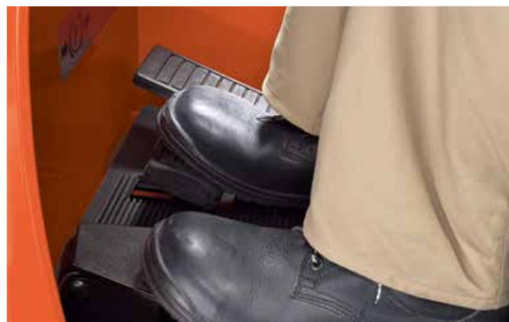
Elektronické brzdění zlepšuje ovladatelnost.
